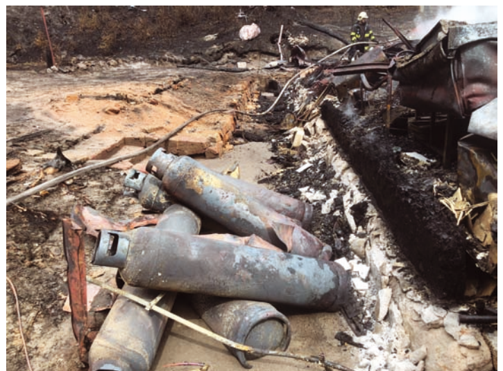
Nebezpečné propanbutanové láhve ve shořelém objektu.
